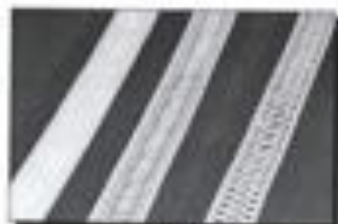
Kleberauren zur flächigen Klebeverbindung
