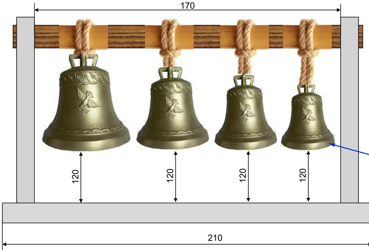
Vier Glocken (**ohne** Klöppel) sind mit Seilen an einem im Querschnitt **rechteckigen** Balken aus Eichenholz angebracht, der mit zwei Haltern aus Stahl auf einer Grundplatte aus Stahl (Abmessungen wie Blatt DIN A4, Dicke 20 mm) abgestützt wird. Der Abstand zwischen Glockenrand und Grundplatte beträgt einheitlich 120mm. Größe und Abmessungen der Glocken sowie die Abstände zwischen den Glocken können sinnvoll angenommen oder entsprechend recherchiert werden.
