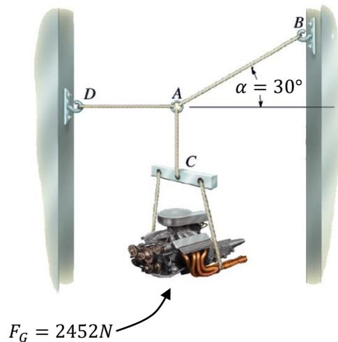
Das ganze System ist im Gleichgewicht (keine Beschleunigung): Dann ist auch Ring A im Gleichgewicht.
