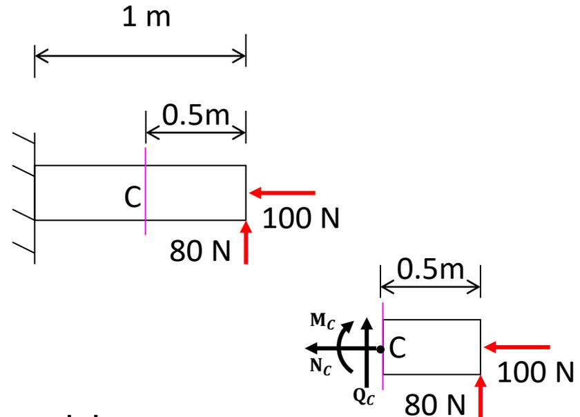
2. Eine Säule wird mit 100N belastet. An welchem Schnitt sind inneren Kräfte am kleinsten?
