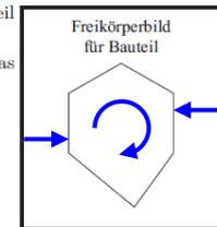
c) Ist es möglich die Wirkung des Schraubendrehers auf das Bauteil durch ein Kräftepaar darzustellen?
