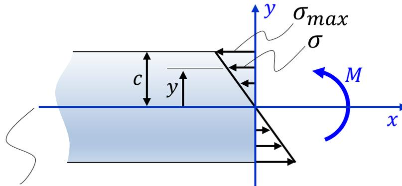
*Neutrale Ebene (Axiale Spannung = 0)*
