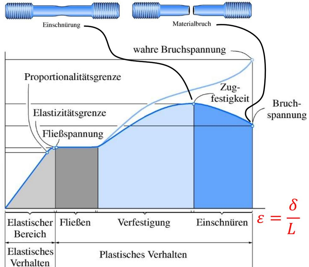
Konventionelles und wahres Spannungs-Dehnungs-Diagramm für duktiles Material (Stahl), nicht maßstabsgerecht
