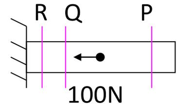
2. Eine Säule wird mit einer Scherkraft belastet. An welchem Schnitt sind die inneren Kräfte am größten?
