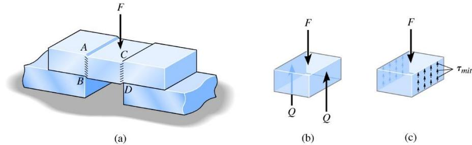
2. Welchen mittlere Schubspannung wirkt auf Fläche AB (oder CD), mit  $F=20\text{kN}$ , und  $A_{AB}=A_{CD}=1000\text{mm}^2$ ?
