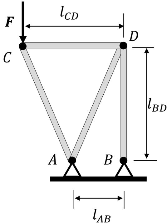
Gegeben ist eine angewandte Kraft  $F = 2000\text{N}$  und die unbelastete Abmessungen  $l_{CD} = 60\text{mm}$ ,  $l_{BD} = 70\text{mm}$ ,  $l_{AB} = 30\text{mm}$ . Bestimmen Sie die Kräfte in allen vier Balken:  $F_{AC}$ ,  $F_{AD}$ ,  $F_{CD}$ ,  $F_{BD}$  und notieren Sie, ob Zug- oder Druckkräfte wirken.
